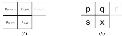
รูปที่ 4. Pixel-based scan mask (P-Mask) ใช้ตรวจสอบหา 8-connectivity (ก) ตำแหน่งของพิกเซล (ข) ตัวอักษรที่ใช้เรียกแทนตำแหน่งต่างๆ
